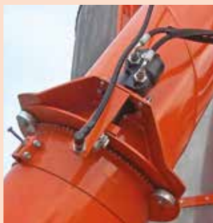
Hydraulic motor for swiveling cap driving Гидравлический мотор привода верхней части подвижной выгрузки
