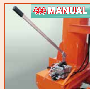
Manual hydraulic pump for auger positioning Ручной гидравлический насос для позиционирования шнека
